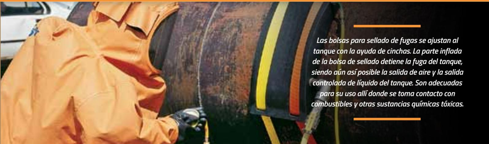
Las bolsas para sellado de fugas se ajustan al tanque con la ayuda de cinchas. La parte inflada de la bolsa de sellado detiene la fuga del tanque, siendo aún así posible la salida de aire y la salida controlada de líquido del tanque. Son adecuadas para su uso allí donde se toma contacto con combustibles y otras sustancias químicas tóxicas.
