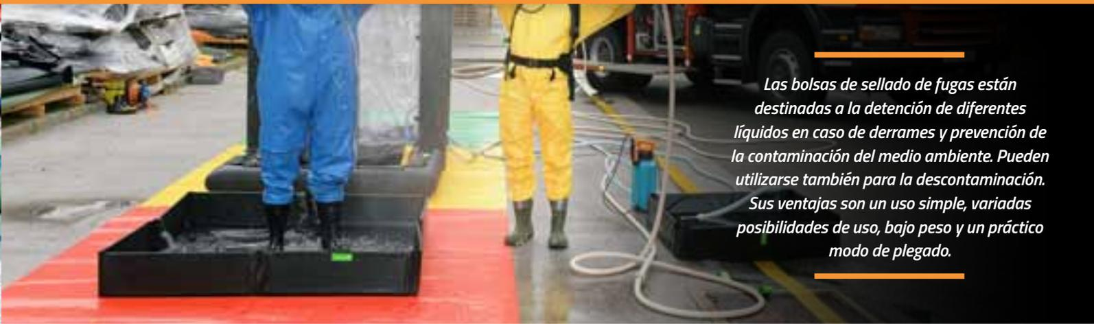
Las bolsas de sellado de fugas están destinadas a la detención de diferentes líquidos en caso de derrames y prevención de la contaminación del medio ambiente. Pueden utilizarse también para la descontaminación. Sus ventajas son un uso simple, variadas posibilidades de uso, bajo peso y un práctico modo de plegado.
